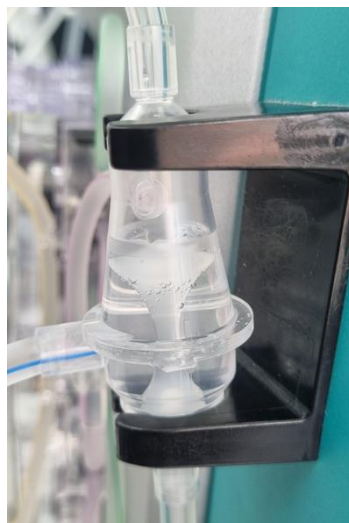
Fig 2: Cámara de desaireación asegurada en el soporte
