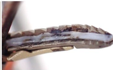
Figura 2. Ejemplo de sonda Thunderbeat según especificaciones (izquierda), deformación de la almohadilla de tejido (centro), desprendimiento de la almohadilla de tejido (derecha)
