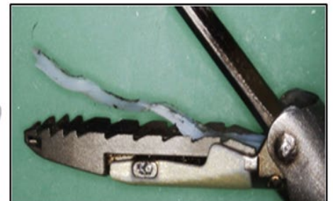
Figura 2. Ejemplo de sonda Thunderbeat según especificaciones (izquierda), deformación de la almohadilla de tejido (centro), desprendimiento de la almohadilla de tejido (derecha)
