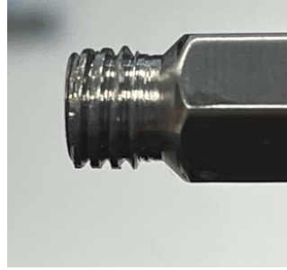
Figura 1. Rosca del introductor dañada
