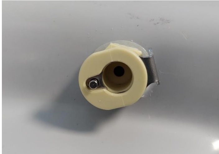
Figura 1: Conector de prueba de estanqueidad en el receptáculo
