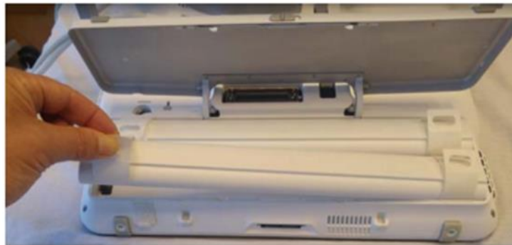
Figura 3-6. Sustitución de la batería
