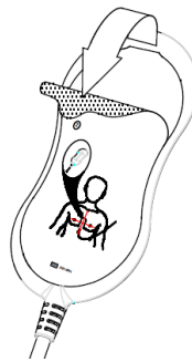
Figura 27 Preparación de la pegatina del Push-pad: retirar el revestimiento frontal
