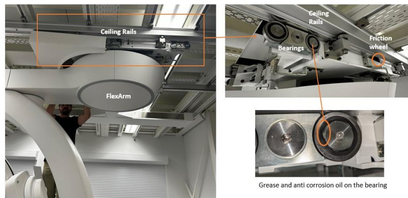
Figura 2. Descripción general de los elementos del soporte FlexArm e identificación de problemas.
